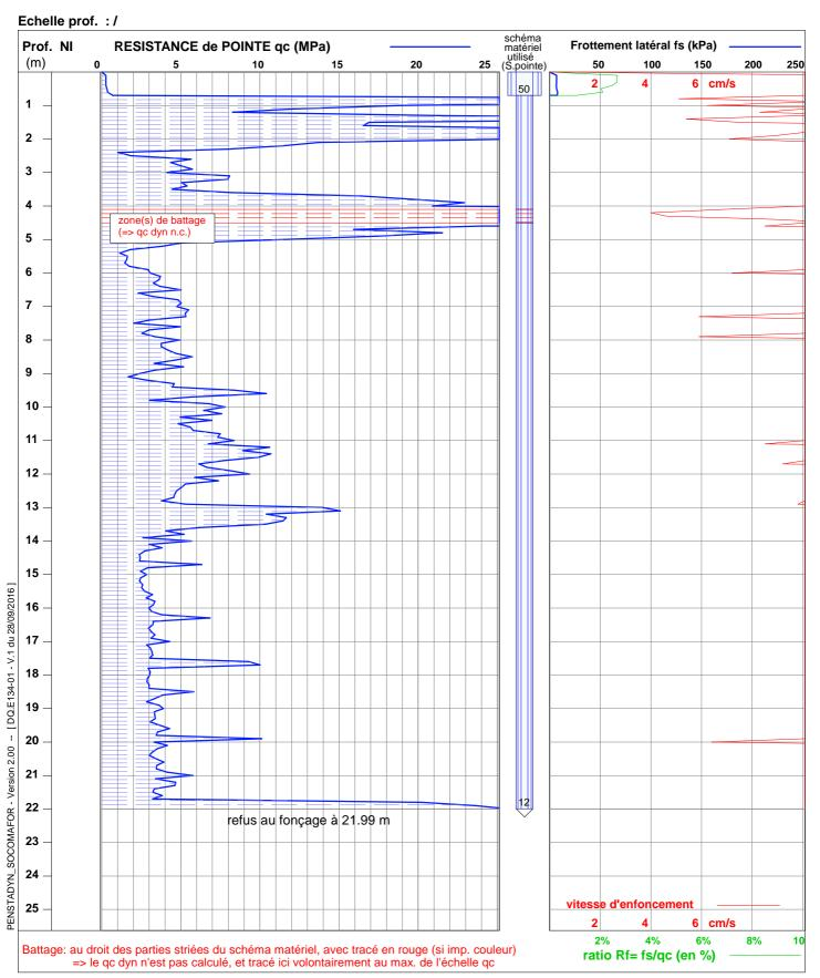
MATERIEL de mesures utilisé: Camion & sondes réf. SOCO\_01, avec pointes de 50.27 cm², puis de 11.95 cm²
