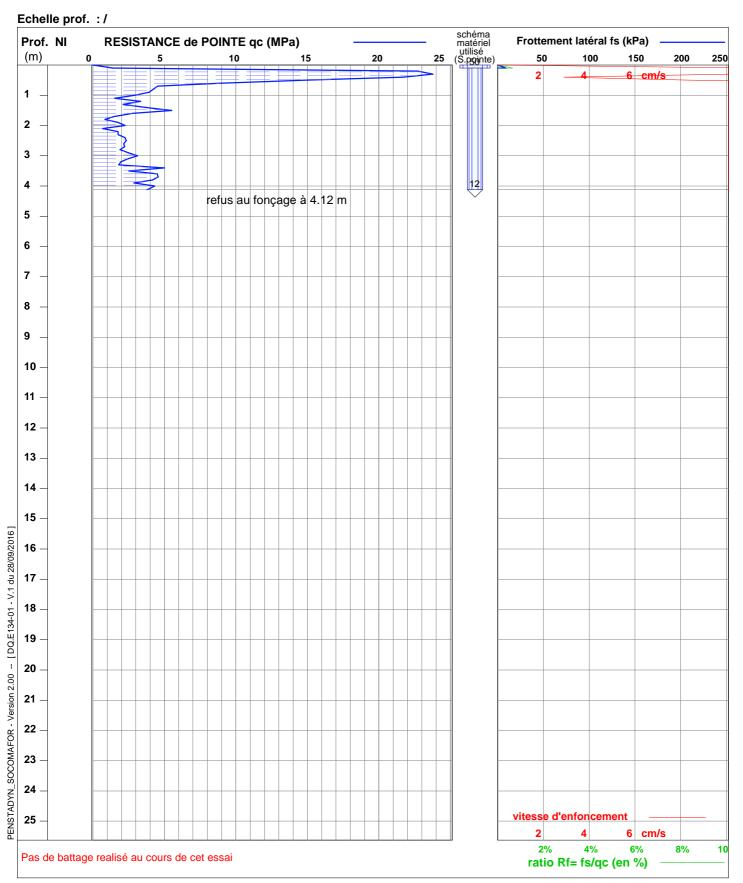
MATERIEL de mesures utilisé: Camion & sondes réf. SOCO\_01, avec pointes de 50.27 cm², puis de 11.95 cm²
