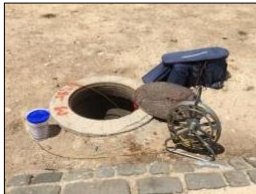
Figure 6 : Exemple du passage d’une aiguille détectable couplé à un générateur (mode actif) dans un réseau gravitaire.
